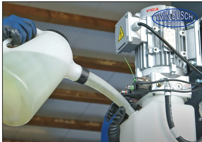
Abbildung: HLP 32 einfüllen
